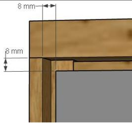
Um das Design „Modena“ zu erzielen werden die Stollen um 25 mm (Push) über einen Falz vorgezogen. Dadurch entsteht eine Fuge zwischen Stollen und Türe von 8mm. Soll oben ebenfalls eine 8mm Fuge zwischen Abdeckplatte und Front entstehen, müssen die Stollen oben um 8mm gekürzt werden.
