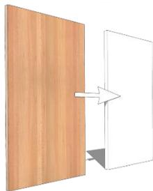
Für die Push-to-open-Technik werden die Bänder ausgetauscht und ein Schnäpper auf der Griffseite angebracht. Es entsteht ein Spalt von 3-5 mm. Informationen innenliegende Fronten: Seite 12.
